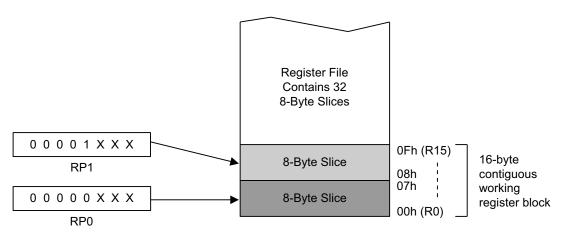
Figure 18. Contiguous 16-Byte Working Register Block
