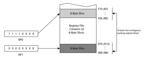
Figure 19. Noncontiguous 16-Byte Working Register Block
